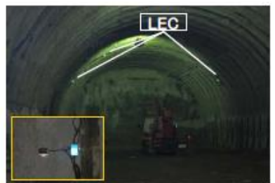
内空変位計とLEC設置状況 (写真提供 西松建設様)
