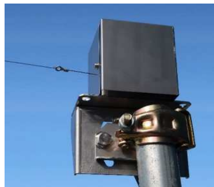
写真は地すべり測定用金具（オプション品）取付時です。
