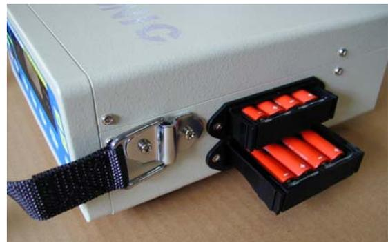
注) **BATT** キーで電圧値をモニタし、10.8V 以下になったら、8本とも同じ種類の新しい電池に交換して下さい。異なる種類や新旧まぜての使用は、故障の原因となります。またご使用にならないときは、液漏れ防止のため、電池を取り外してください。
