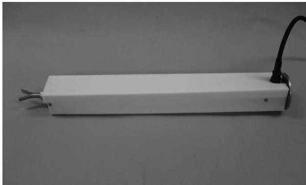
これまでの有効応力計の問題点であった、初期材齢時の無応力状態に圧縮応力が出る点を、縁切り材を低剛性に改良するなどして、材齢初期の段階から十分硬化した段階まで連続して精度良く測定することができます。
