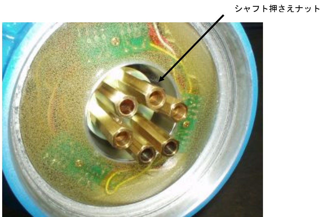
図-5 金具の取り外し
